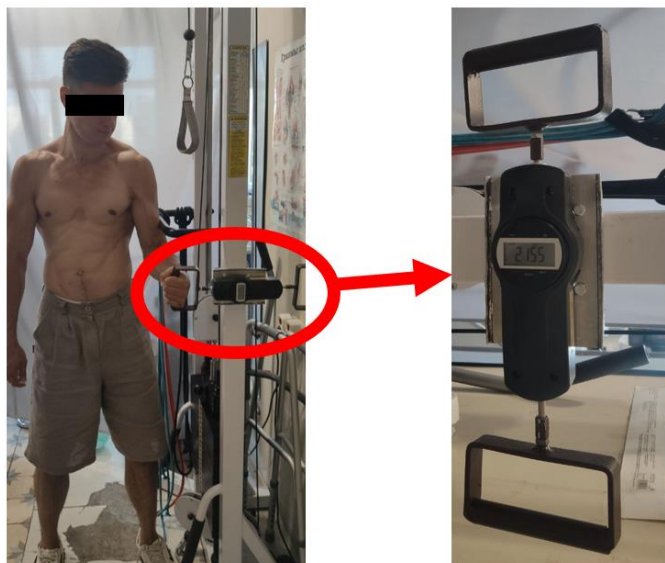
Рис. 2.6. Дослідження ізометричної сили внутрішньої ротації та динамометр SF-500.
